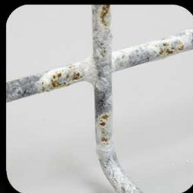
Galvanizado en caliente después de 600 horas
